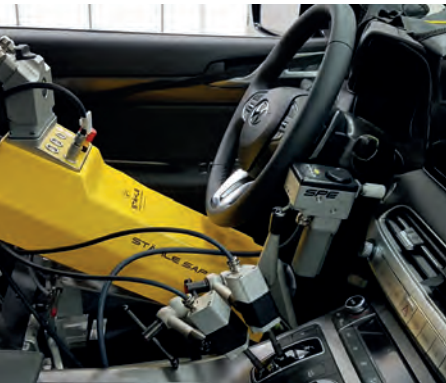
Die STÄHLE AUTOPILOTEN werden weltweit eingesetzt zum Testen von Fahrzeugen, Fahrzeugkomponenten auf Rollenprüfständen und auf Prüfgeländen. Foto: Stähle GmbH
